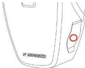
Pav. 23: Pasiūlymas, kur klijuoti lipduką
