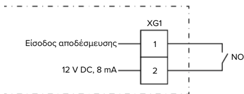
Εικ. 17: Διάγραμμα συνδεσμολογίας: Είσοδος αποδέσμευσης
