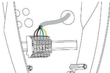
10. Ábra: Feszültségellátás csatlakoztatása
